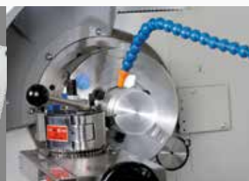
Hochgenaue Spindellagerung mit 3 vorgespannten Schrägkugellagern für hohe Traglast mit zusätzlicher Riemenzugentlastung
