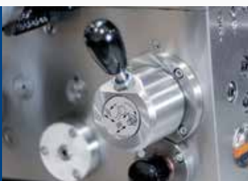
Einhebelschaltung mit Sicherheitsverriegelung
