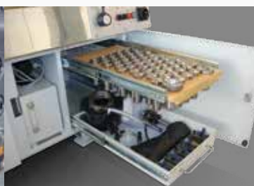
Maschinenunterbau mit herausnehmbarer Spänewanne und abschließbarem Werkzeugschrank für Zubehör
