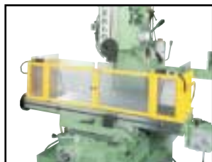
Protección envolvente de la mesa. Table guard protection. Protection de la table. Tischverkleidung.
